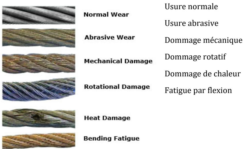
Figure 7 : Exemples de dommages   l' quipement
